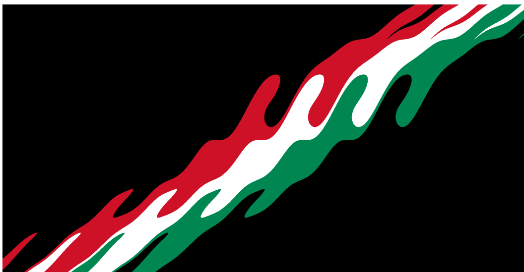
FIGURE 16 – Bassins d'attraction dans le cas A = 4,0 , d = 0,4 . Horizontale : \varphi(0) de 0 à gauche jusqu'à 12 \cdot 2\pi à droite. Verticale : \dot{\varphi}(0) de -12 en haut jusqu'à 12 en bas.
